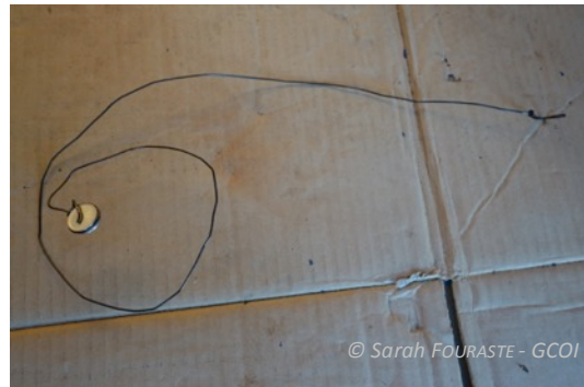
Exemple de dispositif de pose d'un data-logger permettant l'installation et le retrait de la sonde dans une fissure, entre deux poteaux creux
