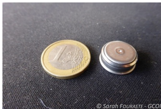
Gabarit d'un data-logger
